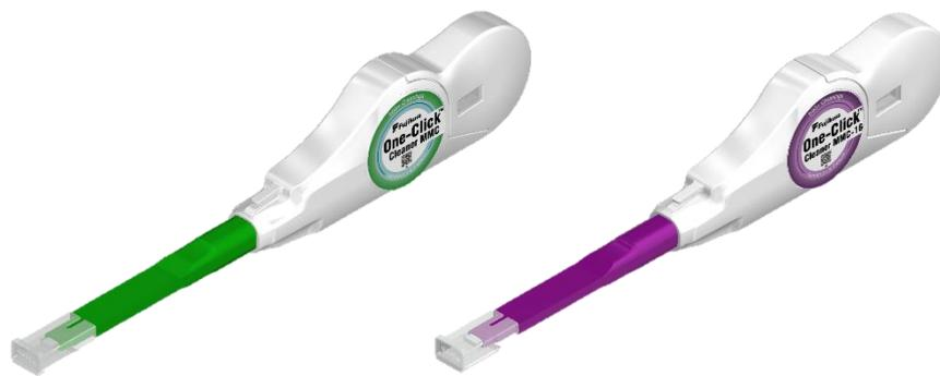
MMC クリーナーは、ノズル及びクリーナー先端の清掃ヘッド形状の最適化を行い、簡単なワンプッシュ動作で MMC ジャンパコードや MMC アダプタのコネクタ端面を素早く効果的に清掃できます。コネクタに損傷を与え、光ファイバネットワークのパフォーマンスに悪影響を及ぼす可能性のある油、ほこり、汚れを除去するのに有効です。
