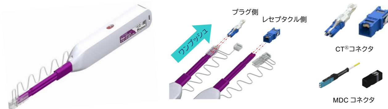
MDC クリーナーは、簡単なワンプッシュ動作でジャンパコードやアダプタのコネクタ端面を素早く効果的に清掃できます。コネクタを損傷を与え、光ファイバネットワークのパフォーマンスに悪影響を及ぼす可能性のある油、ほこり、汚れの微粒子を除去するのに有効です。付属のキャップを使い分けることで、アダプタ(モジュール)内部のフェルール端面とプラグのフェルール端面の両方が清掃可能です。
