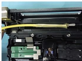
3. 接続部分を抗張力体と一緒に補強スリーブを通し加熱補強する。
